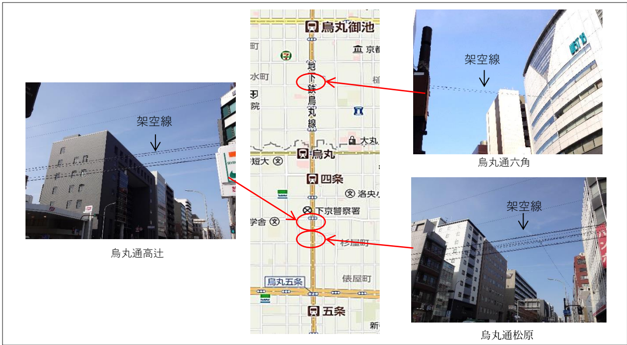
写真 10：無電柱化されている烏丸通りをまたぐ支線やケーブル線
